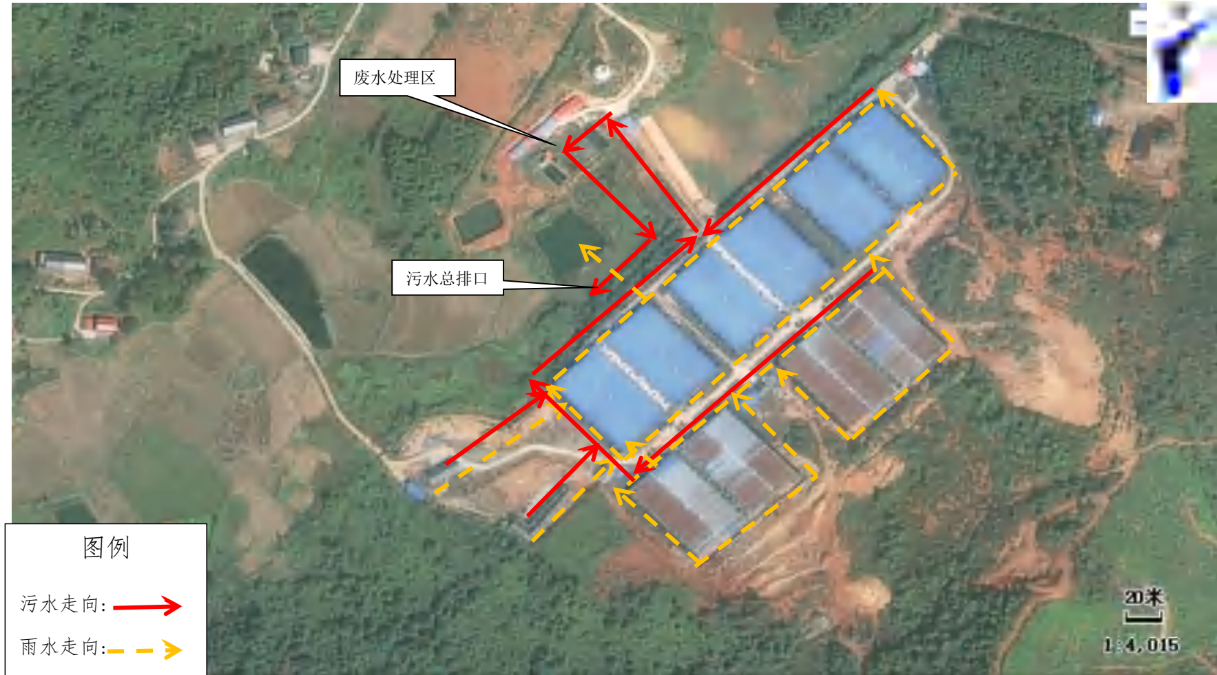
附图 4 厂区雨、污分流路径图
